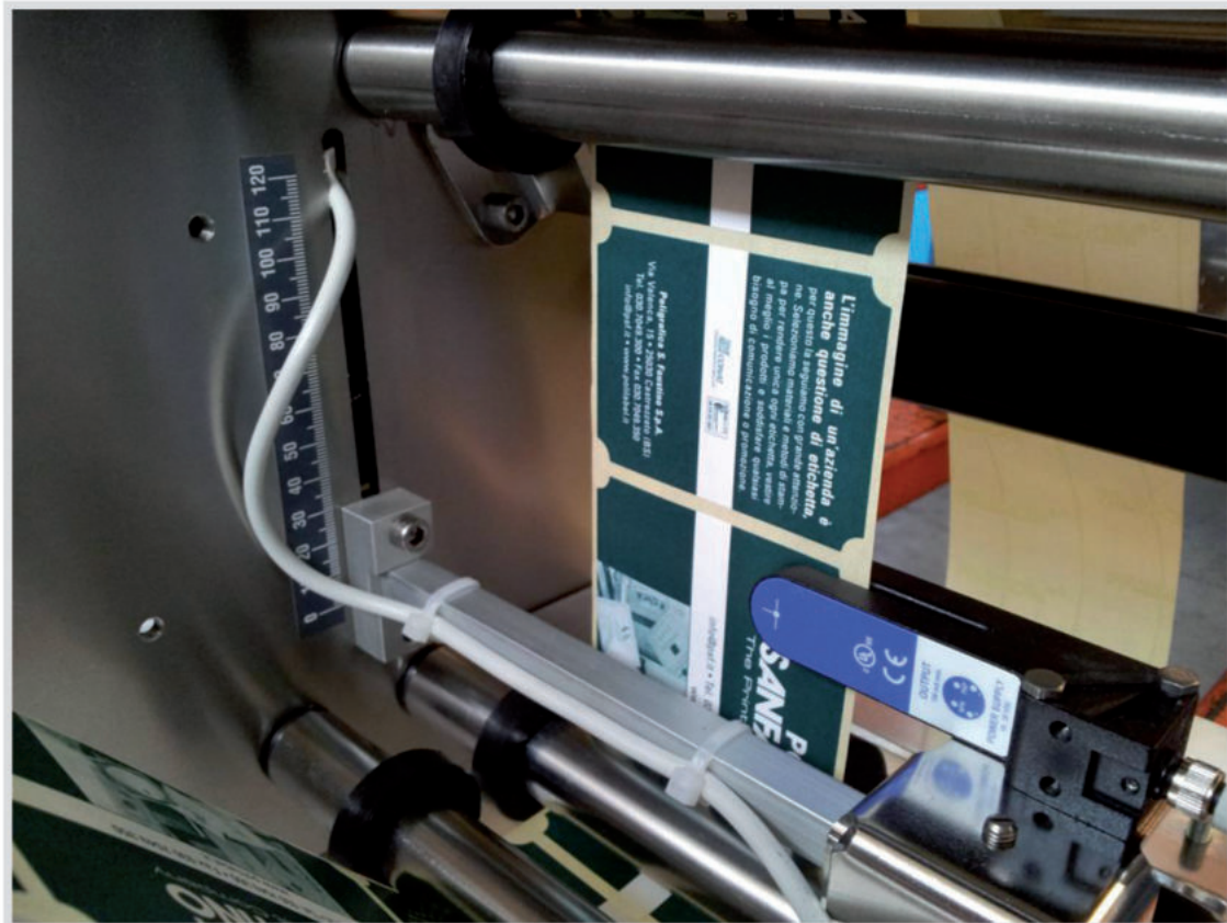
Foto 9.7 Einstellung der Fotozelle für das Etikett
