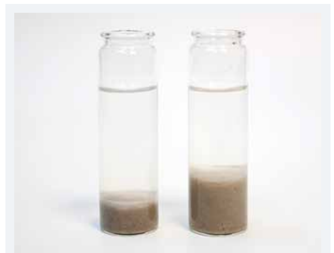
Unterschiedliches Quellverhalten von NaCalit® PORE-TEC (links) und GranuBent® PORE-TEC (rechts)
