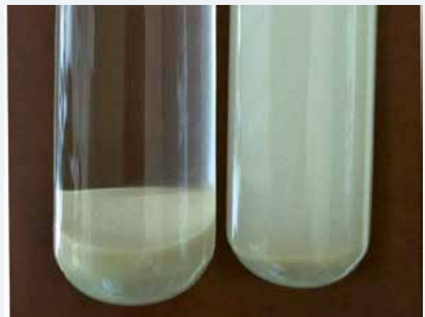
Auflösung von MannoRelease. Das Kombinationsprodukt wurde in einem Tartratpuffer (pH 3,5) aufbereitet und 48 h bei 25 °C inkubiert.
